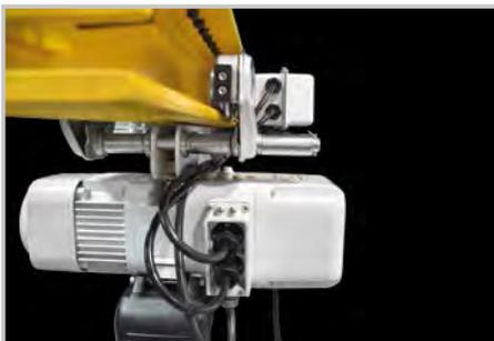
**TSP Rollfahrwerk, Schäfte, Halterungen und Einstellringe komplett vernickelt**
