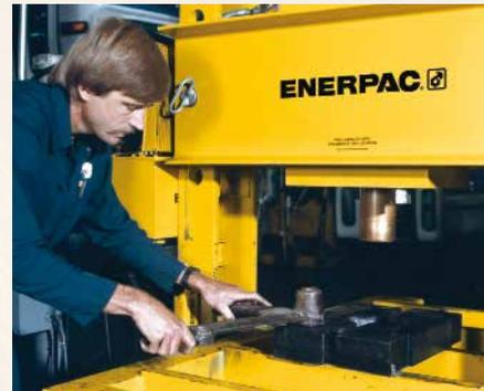
Eine BPR-20075 Rollrahmen-Presse wird zur Entfernung einer großen Welle von einem Lagerbock-Aufbau eingesetzt. Die Rollrahmen-Konstruktion ermöglicht die sichere Beladung dieses schweren Teils mit einem Laufkran.
